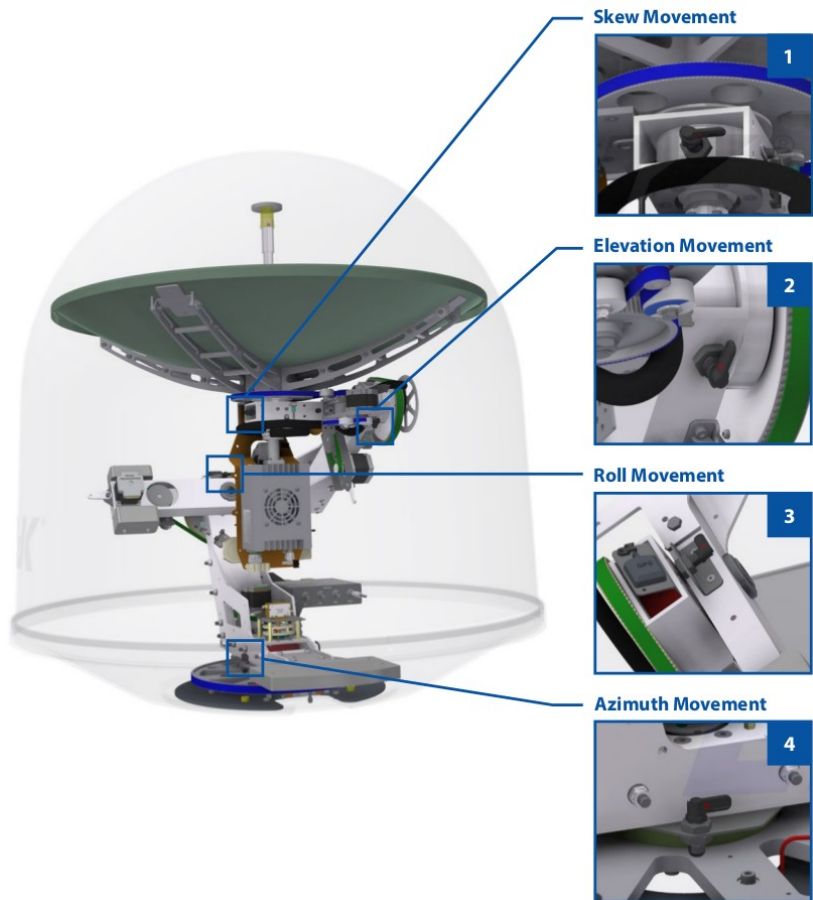
Abbildung 4.6: Position der Transportsicherungen
